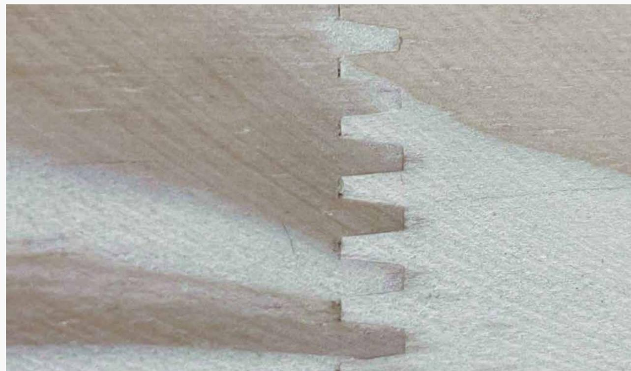
*Figura 09: Madeira colada tipo finger joint*
